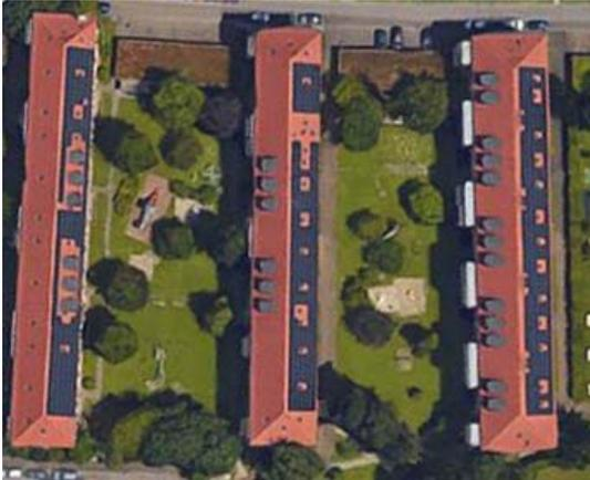
**Bild 3: Aufdach-Photovoltaikanlage auf Siedlung Holeystrasse in Basel, kompakte Fläche mit zulässigen Aussparungen für Dachfenster. Bild aus Google Earth.**
